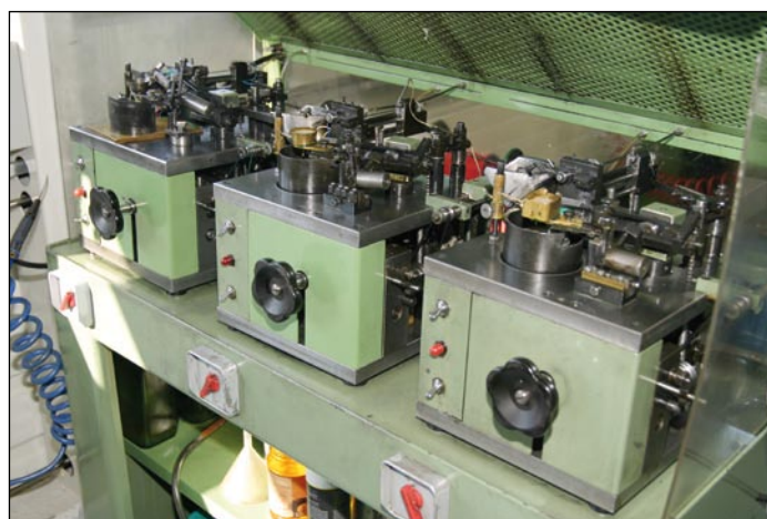
Und auf solchen Apparaten wurden dann zwei Millionen Saphirnadeln pro Jahr gefertigt – pro Nadel betrug die gesamte Schleif- und Polierzeit übrigens nur 10 Sekunden!
